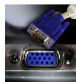
**Puertos VGA:** Es utilizado para los monitores. Este es de forma rectangular, con un recubrimiento plástico para aislar las partes y se ubica en la parte posterior de los monitores y en la parte trasera del PC, cerca del puerto de S-video.
