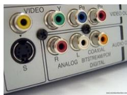
**Puertos RCA:** Es un tipo de conector eléctrico común el cual sirve de medio para transmitir audio y video. Su uso se extiende desde las computadoras hasta los equipos de sonido, etc.
