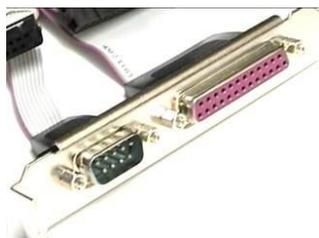
**Puerto Serial (COM):** Se utilizan para enviar y recibir información de BIT en BIT fuera del computador a través de un único cable y de un determinado software de comunicación. Estos se identifican como puertos del COM (comunicaciones). Por ejemplo periféricos que se conectan son mouse y módem. Estos conectores son de tipo macho y los hay de 2 tamaños, uno estrecho, de 9 pines y otro ancho de 25 pines, y realizan las mismas funciones.
