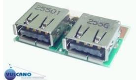
**Puerto USB (Universal Serial Bus):** Se pueden conectar en el cualquier periférico que sea compatible sin necesidad de reiniciar la computadora ni configurar el sistema.. El USB es la tecnología preferida para la mayoría de los teclados, mouse y otros dispositivos de entrada de información como cámaras fotográficas digitales, impresoras, escáneres, módems, joysticks y similares.
