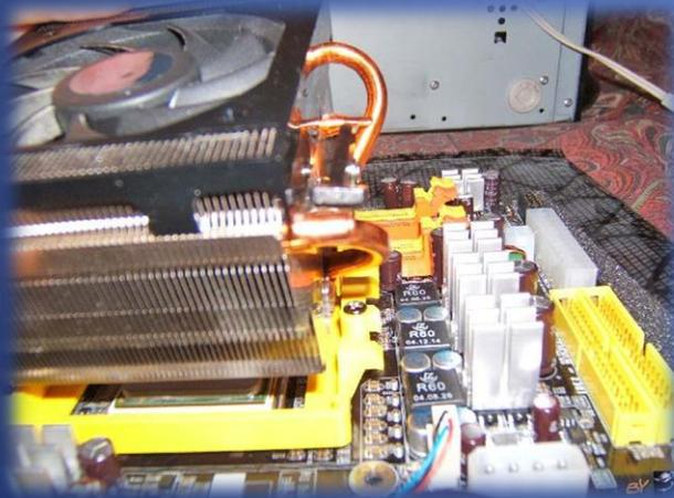
□ Colocamos encima el disipador, asegurándonos de que hace contacto con la pasta térmica. Una vez colocado, anclamos el disipador según el mecanismo proporcionado por el fabricante.
